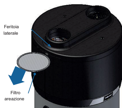
Fig. 20 – Dettaglio filtro di areazione
